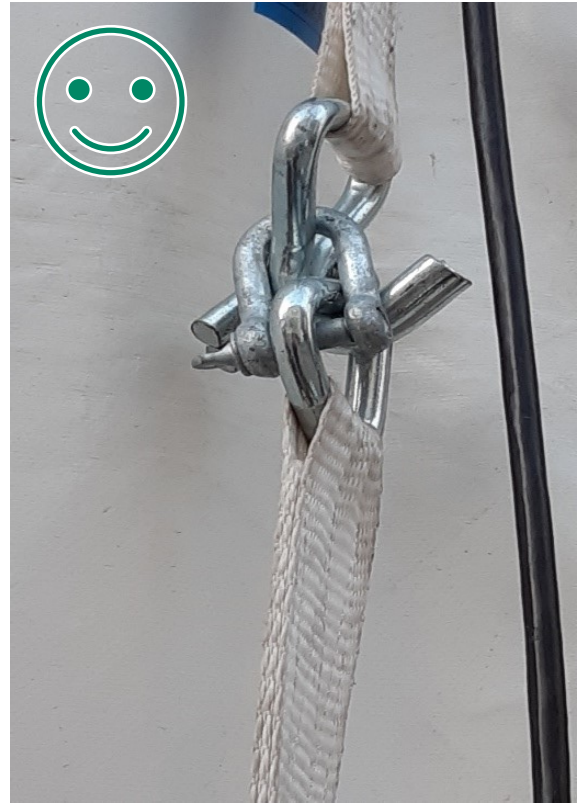
Kuva 8 HYVÄ TAPA. Koukut lukittu sakkellilla.
