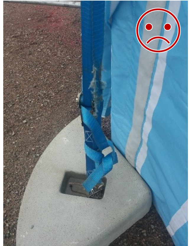
Kuva 10 Ei NÄIN. Kuormaliina on kulunut.
