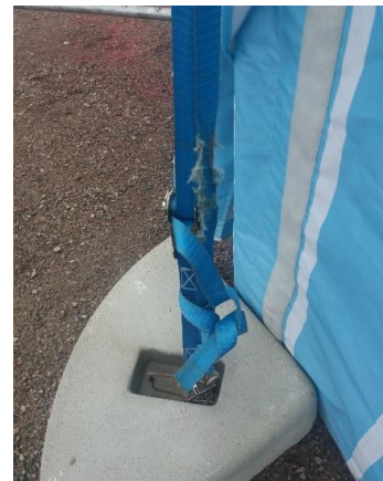
Kuva 10 EI NÄIN. Kuormaliina on kulunut.
