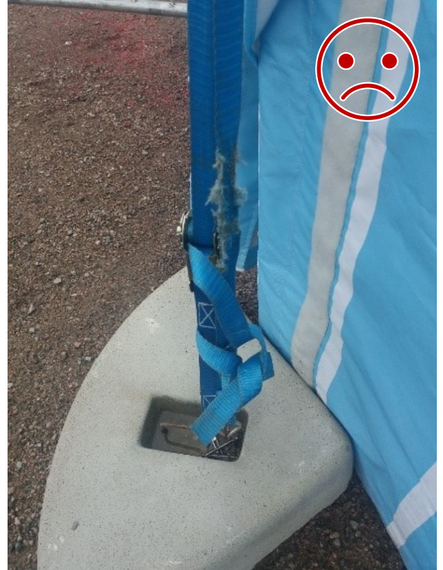
Kuva 10 Ei NÄIN. Kuormaliina on kulunut.
