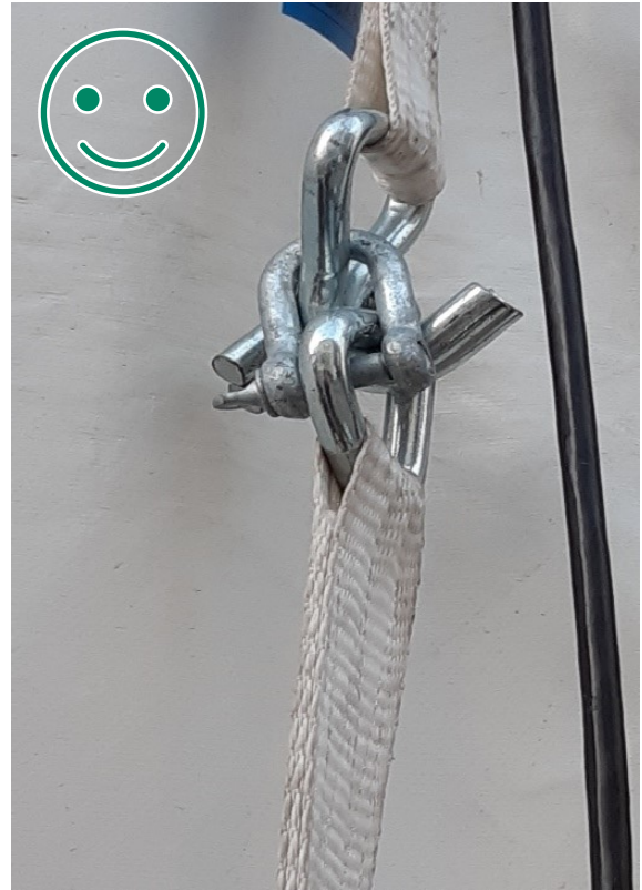
Kuva 8 HYVÄ TAPA. Koukut lukittu sakkellilla.
