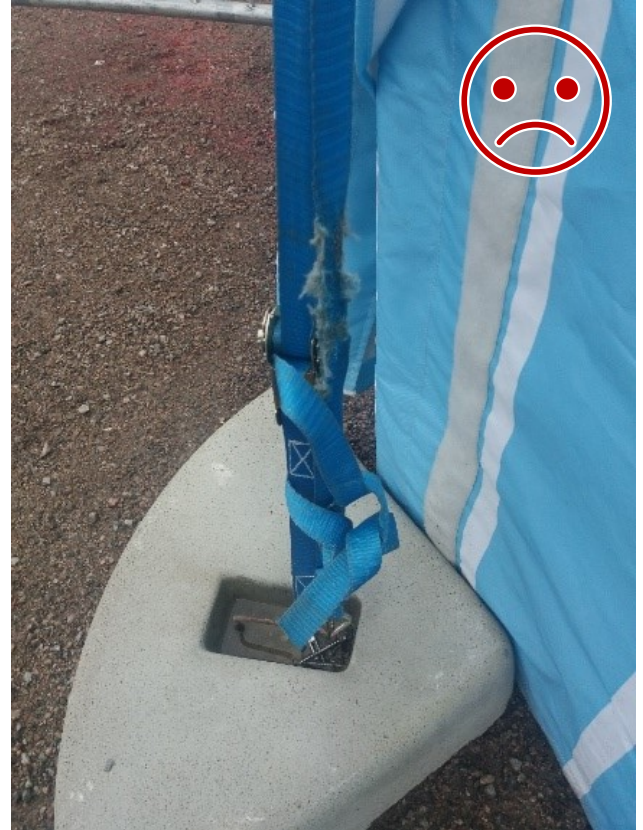
Kuva 10 Ei NÄIN. Kuormaliina on kulunut.
